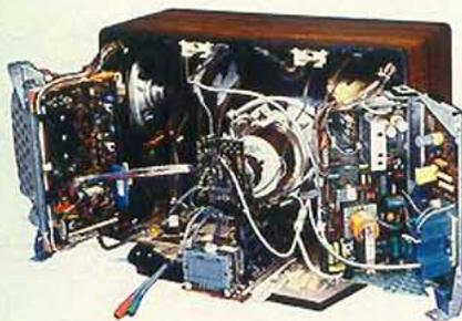
tions annexes sont réalisées à l'aide de semi-conducteurs (circuits intégrés, transistors diodes, diodes lumineuses). Cette technique a comme avantage de consommer juste le courant nécessaire à chacune des fonctions, sans échauffement, ce qui accroît notablement la fiabilité des composants et par voie de conséquence du récepteur lui-même.
