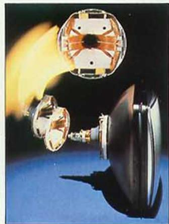
De plus, grâce à l'utilisation de nouveaux canons à électrons, on obtient une amélioration de la finesse du spot et son homogénéité sur toute la surface de l'écran.
