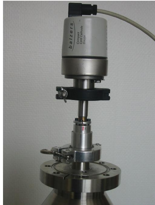
En intercalant un tube simulant le queusot on arrive péniblement à  $1,5 \cdot 10^{-4}$  torr après 15 minutes, et  $5,95 \cdot 10^{-5}$  torr au bout d'une demi-heure.
