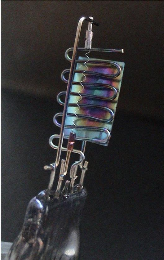
Juste pour vérifier...un filament...une 'grille' (en fait un bout de fil plié en zig zag)...une 'plaque'...le tout dans une enceinte maintenue sous vide par une pompe....on alimente.
