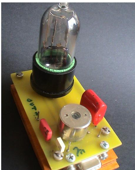
Premier montage avec une diode 'symétrique' et un pot de ferrite.
