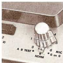
Separata volymrattar för avspelningsstyrkan på båda kanalerna. "Sound on Sound" med tre lägen: AB-test, normal, "Sound on Sound".
