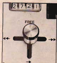
En-spak betjening av hurtig frem- og tilbakespuling og normal fremdrift for opptak og avspilling.
