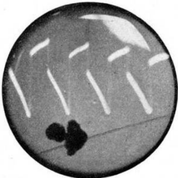
Forme d'onde sur la plaque du multivibrateur d'Abraham et Bloch.
