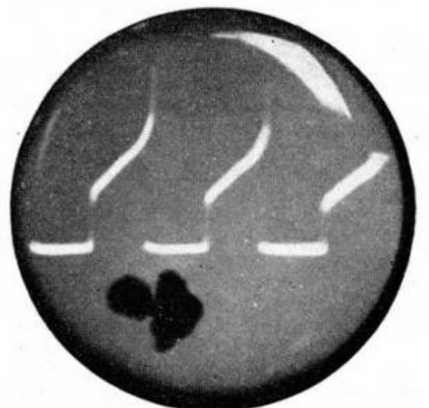
Forme d'onde sur la grille du multivibrateur d'Abraham et Bloch.
