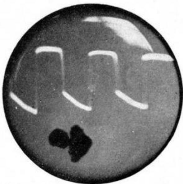
Forme d'onde sur la cathode du multivibrateur d'Abraham et Bloch. La tache noire et un défaut du tube cathodique.
