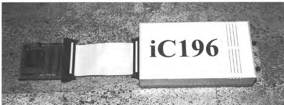
Figure 7 – Voici l'un des produits les plus modernes destinés aux membres de la famille du 80C196, l'iC196, un émulateur en temps réel en circuit. (Document iSYSTEM)
