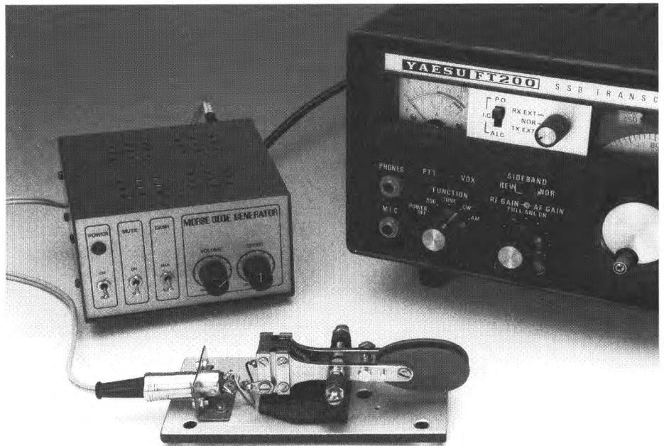
de ferblanterie pour fabriquer les traits et les points du code morse. Quatre circuits intégrés de la série 74HC suffiront à cette tâche. Un boîtier, un morceau de circuit imprimé pour expérimentations, quelques boutons, fiches et prises et vous serez parés !
