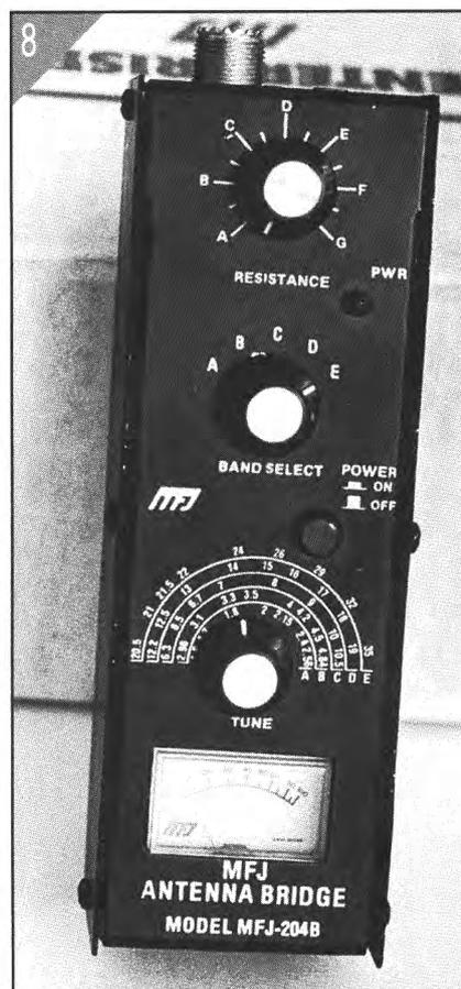
Figure 8 : Pont d'antenne portatif autonome de MFJ.
