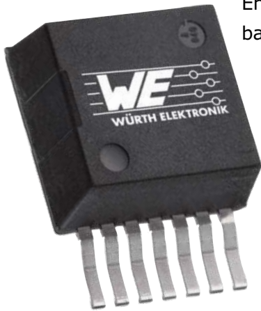
Figure 1. Les régulateurs en boîtier TO263-7EP
