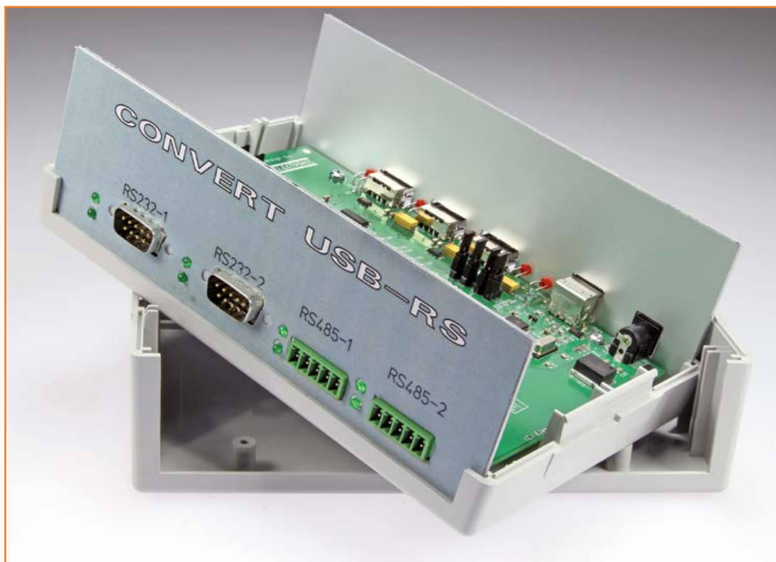
Figure 5. Le convertisseur dans son boîtier avec la façade dessinée par l'auteur.
