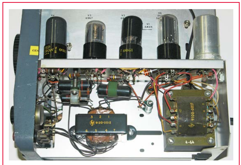
Figure 6. Les sections amplificateur et alimentation du HP 200AB.
