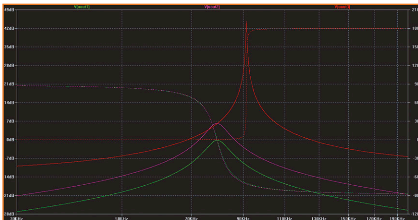
Figure 9. Réponses en fréquence des circuits de la figure 8 : vert = Uout1, mauve = Uout2, rouge = Uout3.
