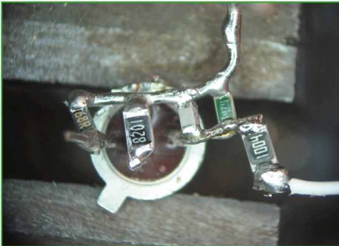
Photo 1. L'important pour obtenir un générateur à avalanche très performant est de réduire au maximum les inductances parasites. Ici les composants CMS sont directement soudés sur les pattes du transistor.
