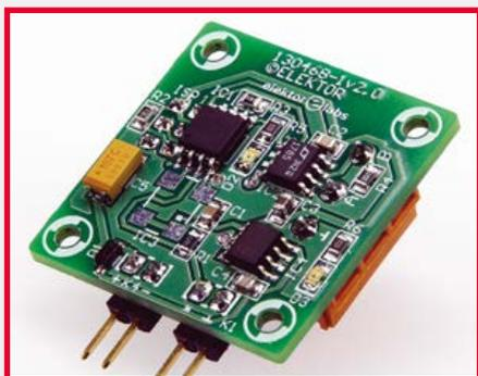
**module capteur pour ElektorBus**
