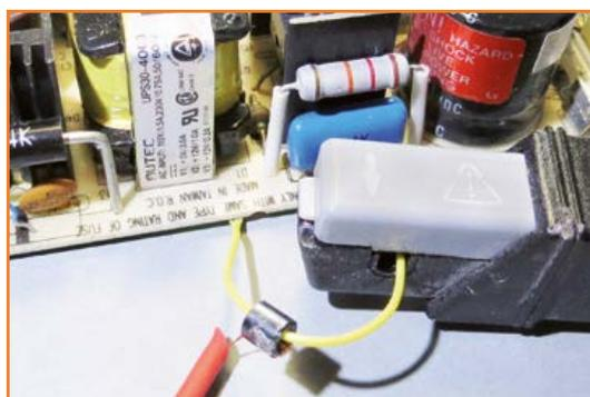
Figure 11. Mesure de courant avec perle de ferrite.
