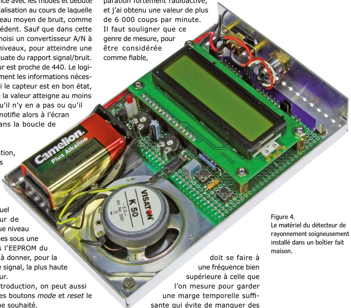
Figure 4. Le matériel du détecteur de rayonnement soigneusement installé dans un boîtier fait maison.
