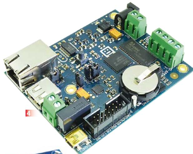
équipée du processeur ARM9 LPC3131 de chez NXP et fonctionne avec un système Linux préinstallé qui s'amorce depuis une carte SD. Les interfaces essentielles au microprocesseur, comme I2C, SPI, la ligne PWM, les E/S numériques ou encore les entrées analogiques, sont dirigées vers l'extérieur.
