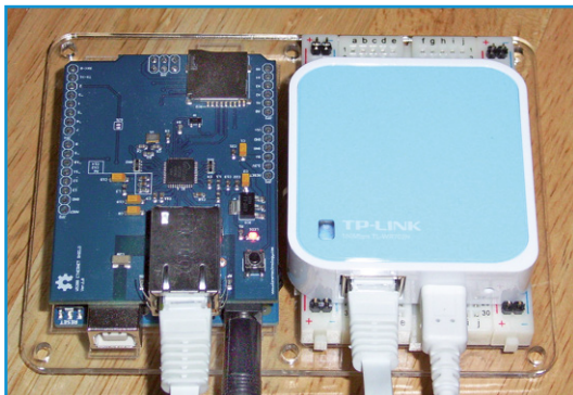
Figure 6. Les bornes mobiles à bas coût comme ce TP-Link NanoRouter rendent le passage d'Ethernet à WiFi très facile ; vous n'aurez même pas à toucher au logiciel.
