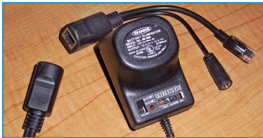
Figure 5. Il ne vous faudra que quelques adaptateurs et une alimentation variable pour mettre en place votre propre solution Passive PoE.
