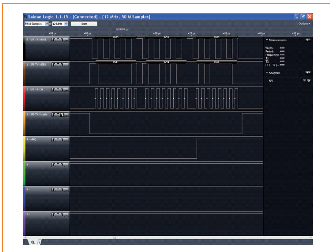
Figure 2. Représentation d'un octet avec l'analyseur logique.
