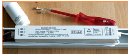
Figure 4. La lampe ouverte montre le ballast électronique.
