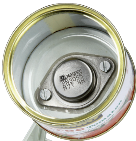
Figure 3. Le montage du 2N3055 sur le fond de la boîte. Il faut encore mastiquer le transistor pour assurer l'étanchéité de l'ensemble.
