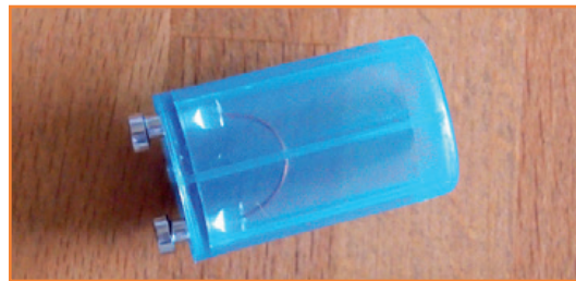
Figure 3. Le pseudo-starter livré avec le tube ne contient qu'un morceau de fil, facile à reconnaître.
