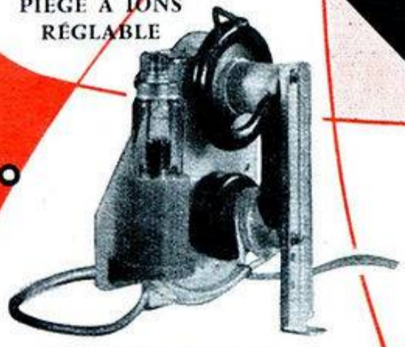
TRANSFORMATEUR DE SORTIE LIGNES T.H.T. 90°
