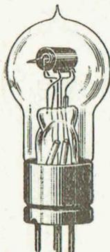
**Radio-Major**, type E 251, filament 5 v. 6 - 2 A. 15, plaque 800-1500 v., saturation 110 millis, résistance 20.000  $\omega$ , puiss. utile 40-45 watts. N° 902.
