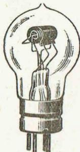
**Radio-Phone**, type E 121, filament 5 v. 6 - 1 A. 8, plaque 700-800 v., saturation 112 millis, coefficient d'amplification 40-45, résistance 69000  $\omega$ , puissance utile 15 watts, N° 901.
