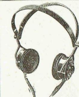
**Écouteur réglable C.E.M.A.**, rendement supérieur, réglage par bouton moleté, résistance 4000  $\omega$ , disposition spéciale des aimants, noyau feuilleté ; convient parfaitement pour réaliser un haut parleur :
