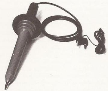
Cette sonde à haute tension permet de mesurer les tensions allant de 1 à 40 kV avec une précision de 1 % à 25 kV. Son rapport d'atténuation est de 1 000 : 1. Cette sonde se connecte directement sur l'entrée de chaque multimètre.
