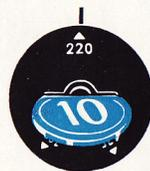
Verwenden Sie keine reparierte und keine im Wert abweichende Sicherung (siehe techn. Daten).
