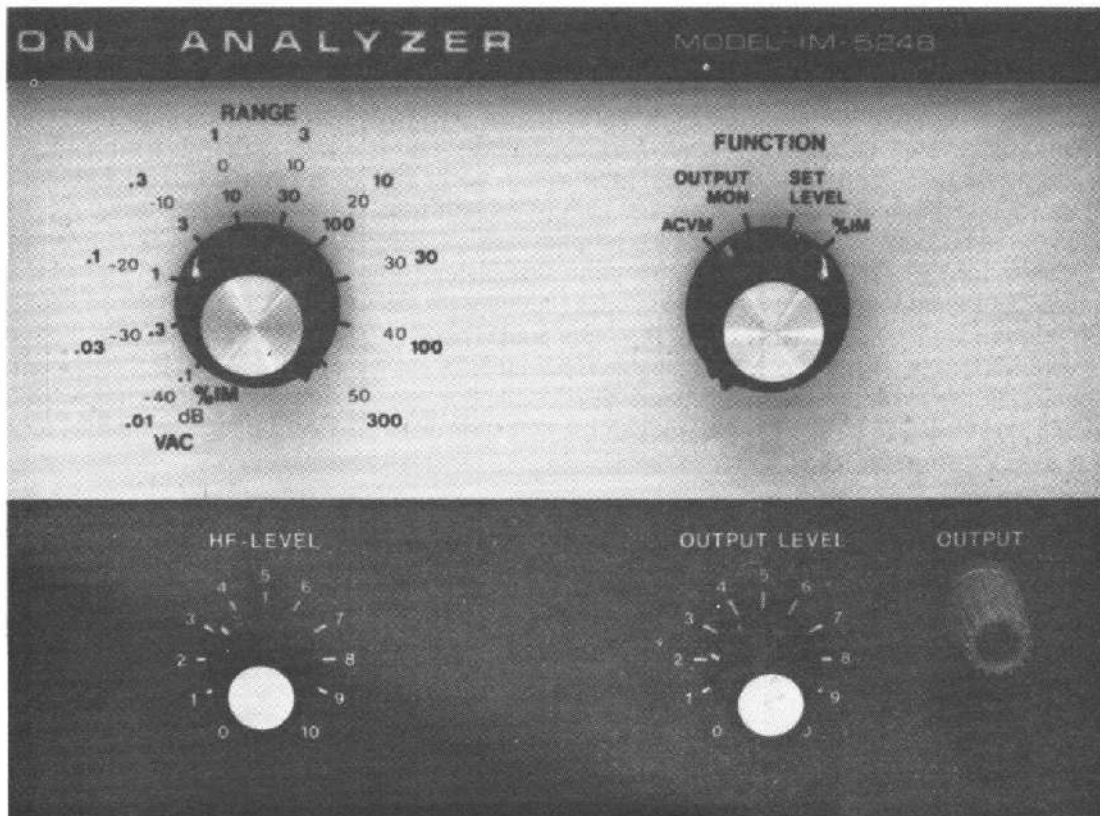
Photo A. - Une vue qui permet de se rendre immédiatement compte des possibilités offertes par l'appareil. On notera la multiplicité des échelles, dB, volts alternatifs de %IM.
