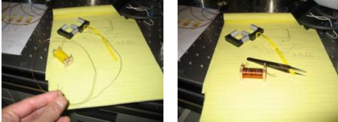
Figure 39 : Etape de démontage et de remontage du primaire du transformateur
