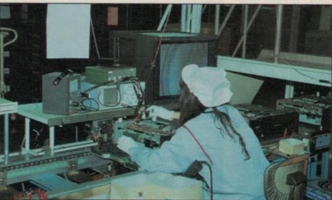
Réglage d'un lecteur de Laserdisc sur l'une des chaînes de fabrication de présérie d'Hachiogi.
