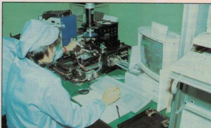
Vérification en grandeur réelle des têtes laser, ici sur un lecteur de CD de laboratoire...
