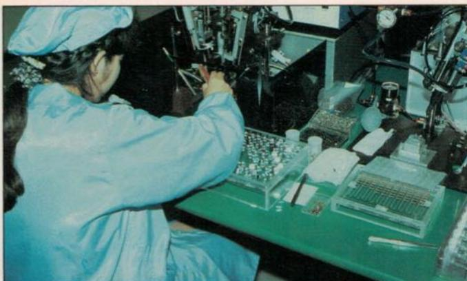
Montage d'une lame demi-onde et de prisme, ces éléments sont collés, l'adhésif distribué par doseur, le durcissement se fait par rayons ultraviolets.
