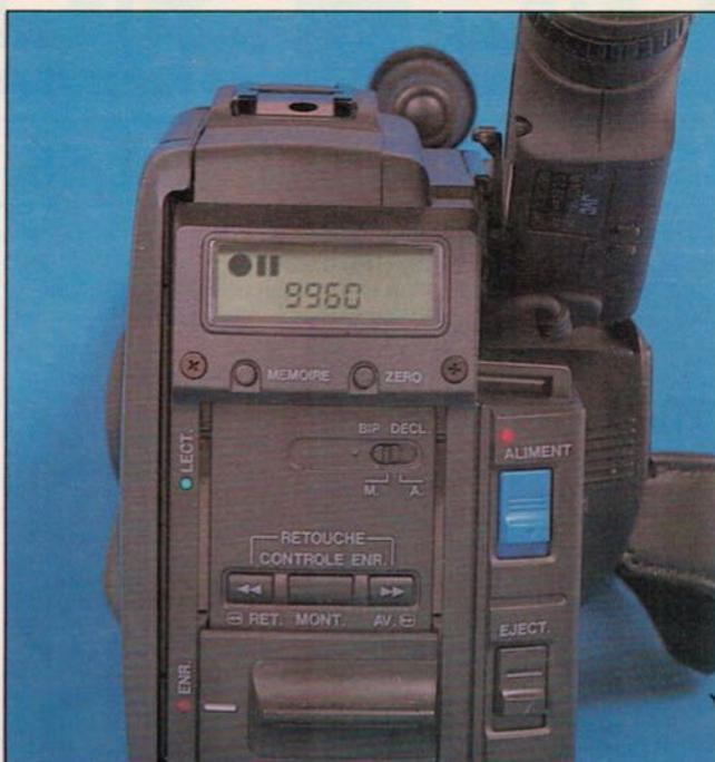
L'une des faces où se rassemblent les touches, ici, on commande le fondu, on débraye les automatismes et on choisit la vitesse d'obturation. Un volet coulissant présélectionne le mode d'exploitation : prise de vue ou lecture, et ne laisse apparaître que les touches utiles. Indispensable en lecture : le compteur, qui évite d'avoir à regarder dans le viseur.
