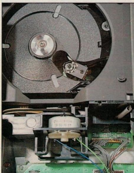
Un classique : le bras oscillant du mécanisme CDM4.
