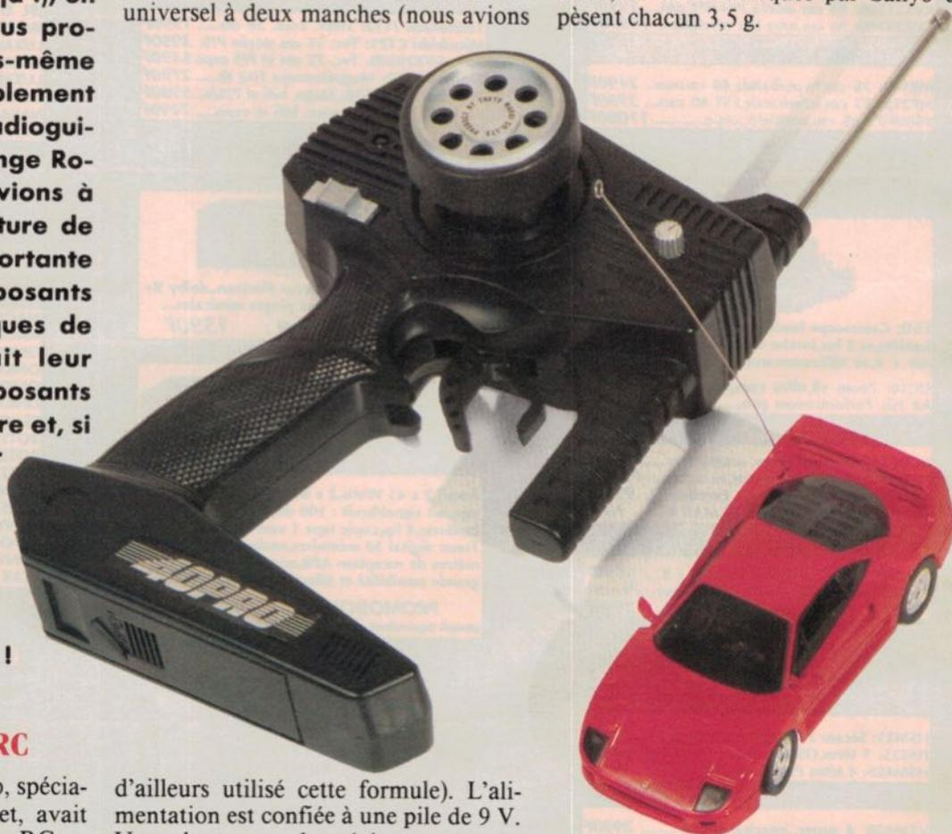
d'ailleurs utilisé cette formule). L'alimentation est confiée à une pile de 9 V. Un volant caoutchouté à centrage par ressort commande la direction, un ajustable sert de trim pour corriger la trajectoire en ligne droite. Une masse métallique alourdit l'ensemble et équilibre l'antenne, la tenue est assez confortable mais vous devrez conduire de la main droite, en tenant l'émetteur de la gauche. La commande de direction a un
