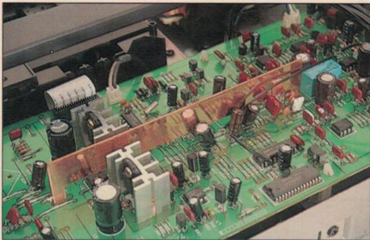
Marantz a installé un potentiomètre de volume motorisé, activé par la télécommande.
