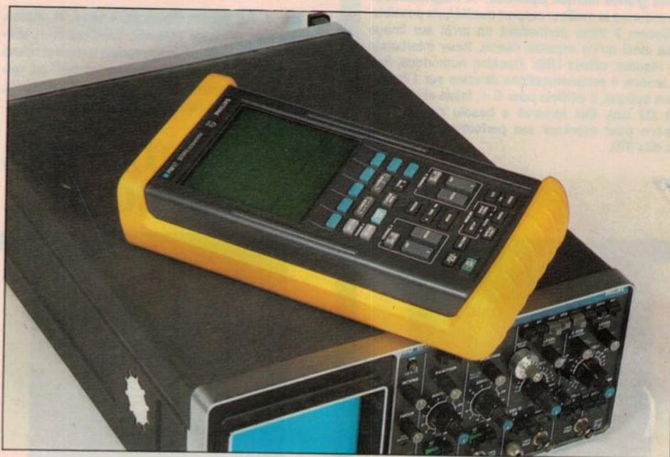
classique mais profite de la surface de l'écran pour afficher deux données en même temps, tensions continue et alternative. La sélection de gamme est automatique, avec passage instantané en manuel. C'est un 3 000 points qui permet une mesure de tension alternative, tension continue, mesure de résistance et de diode. Pas de mesure de courant ici, on devra installer un shunt externe.
