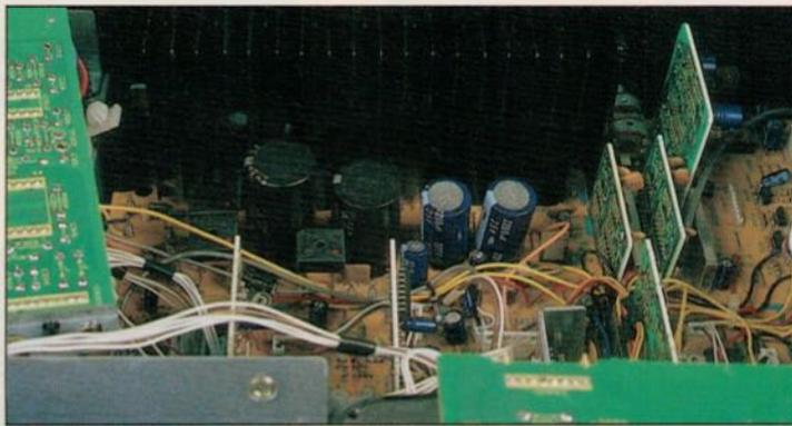
**SL-P10.** L'alimentation. La taille du transformateur laisse supposer une puissance absorbée d'environ 60 W ! Notez la taille des radiateurs et des condensateurs de filtrage. Aujourd'hui, de tels composants ne sont plus employés que sur le haut de gamme.
