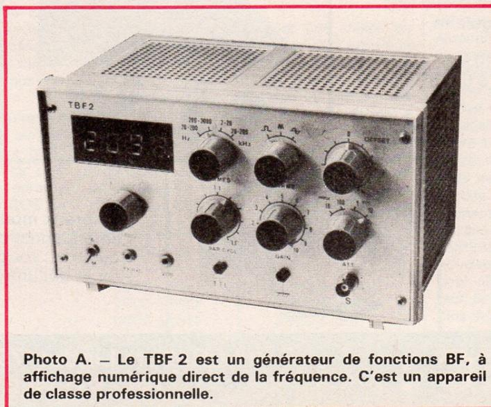
Photo A. — Le TBF 2 est un générateur de fonctions BF, à affichage numérique direct de la fréquence. C'est un appareil de classe professionnelle.
