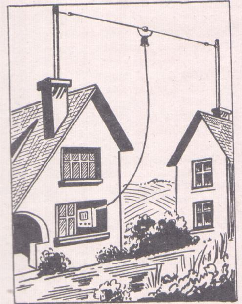
Fig. 3. - Montage d'une antenne en doublet pour les ondes courtes.
