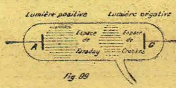
ques. Comment expliquer l'existence de ces rayons ? Crookes suppose l'existence d'un bombardement de la matière radiante (1886). Il admet que les molécules restantes du gaz dans le tube T se chargent à la cathode d'électricité né-
