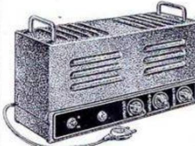
Push-Pull 12 watts Sensibilité : 50 mV Micro - 500 mV PU ou Radio. Réponse : 30-20 000 c/s ± 1 dB. Puissance de sortie : Maximum 12 W. Distorsion : > à 0,5 % pour 10 W de sortie. Contrôle de tonalité : aiguës : - 9,5 dB à + 9,5 dB. graves : - 4 dB à + 5 dB. Coffret givré, dim. : 330x160x120 mm. **179,00** ABSOLUMENT COMPLET, en pièces détachées ....
