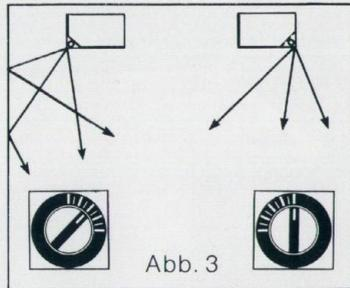
3. Im Wohnzimmer ist nur eine reflektierende Wand. Rechts führt eine Doppeltür oder ein Wanddurchbruch zum Nebenraum. Der linke Lautsprecher wird so eingestellt, daß der Schall von der Wand reflektiert wird. Der rechte strahlt dagegen überwiegend in den Raum. (Abb.3).
