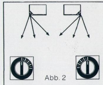
2. Sind Schrankwand bzw. Regal mehr als 1 Meter von den Seitenwänden entfernt, wird der Schall durch eine andere Einstellung etwas stärker in den Wohnraum abgestrahlt. Diese Einstellung ist auch von Vorteil, wenn die Seitenwände mit schalldämpfenden Teppichen, Vorhängen oder schweren Stofftapeten verkleidet sind. (Abb.2).
