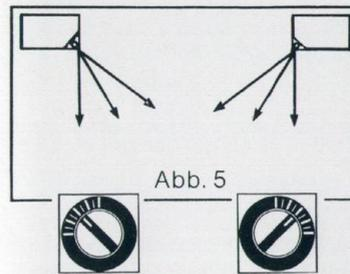
5. Ein Beispiel für extrem ungünstige Hörbedingungen. Ein Wohnraum mit sehr geringer Breite. Aus optischen Gründen müssen beide Lautsprecher aber in der Nähe der schmalen Seitenwände aufgestellt werden. In diesem Fall werden beide Lautsprecher vertauscht. Der linke Lautsprecher wird rechts, der rechte Lautsprecher links aufgestellt. Durch die entsprechende Einstellung am AkustiKnopf® wird der Schall breit in den Wohnraum abgestrahlt. (Abb.5).
