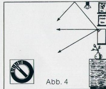
4. Selbstverständlich läßt sich der BOSE 301 auch senkrecht aufstellen. In diesem Fall wird der AkustiKnopf® so justiert, daß der Schall mehr zur Decke strahlt. (Abb.4).
