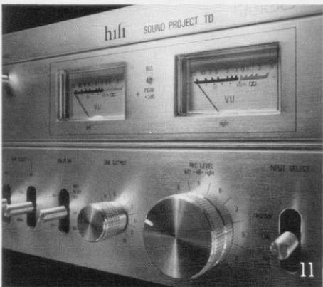
abgestimmt in Technik und Design: Es übertrifft in allen Werten die Forderungen der DIN 45500. Das EK 3537 ist ein Frontlader (Bilder 10 und 11), alle Bedien- und Anzeigelemente befinden sich vorn. Es hat einen Longlife-Tonkopf und einen Longlife-Löschkopf (Bild 12), zwei dreistufige Schalter für Vormagnetisierung und Entzerrung, damit alle
