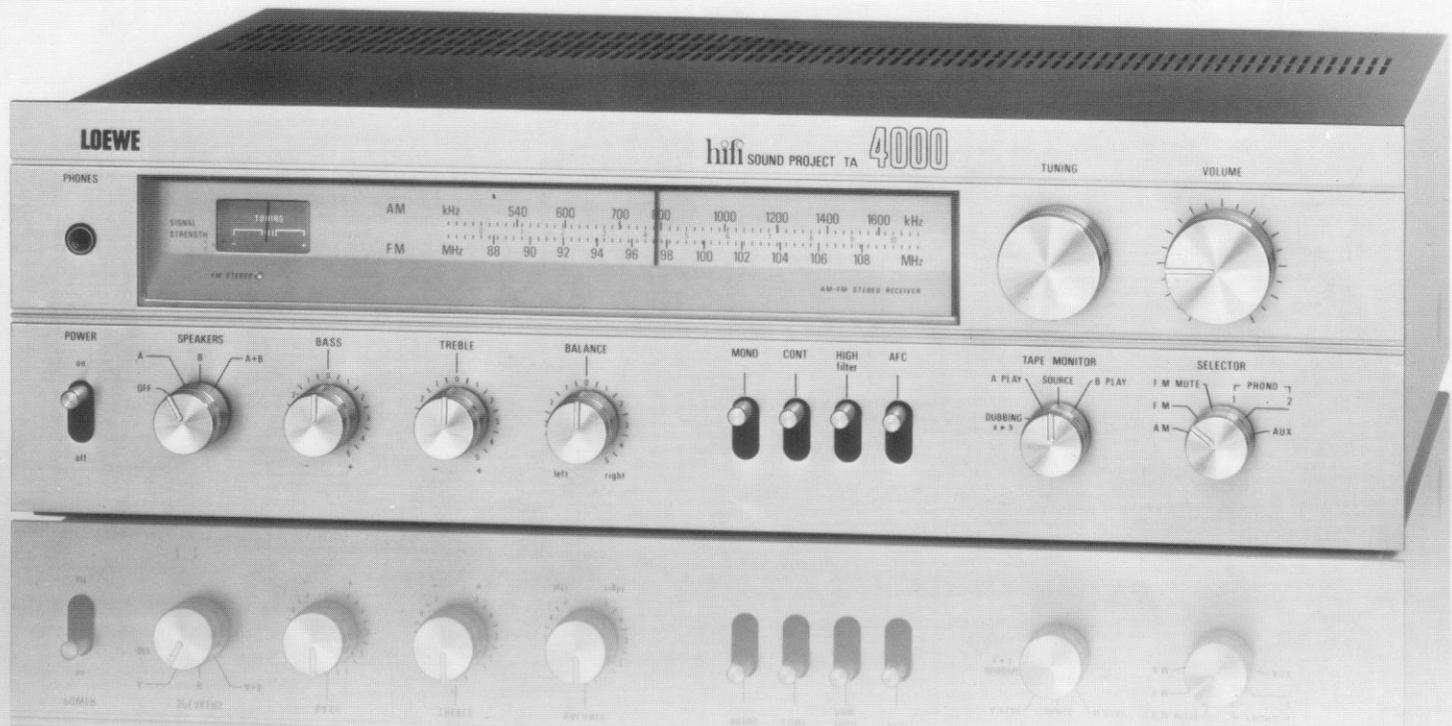
MW-Tuner hat eine UKW-Empfindlichkeit von 2,5  $\mu$ V an 300 Ω. Ein Kombi-Instrument für Feldstärke und Sender-Mitten-Anzeige und die breite analoge Skala ermöglichen das präzise Einstellen eines gewünschten Senders, wobei die AFC-Schaltung den optimalen Abstimmungspunkt ermittelt. Stereo-Sender werden durch eine Leuchtdiode angezeigt. Durch die zahlreichen Anschlüsse und den großen Schaltungsaufwand ist es möglich, mit dem Receiver Loewe TA 4000, Typ SX 6772 auf zwei Tonbandgeräte
