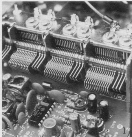
satz eines hochwertigen PLL-Stereo-Decoders (Bilder 2 und 2a) wird eine Stereo-Kanal-Trennung von 45 dB erreicht, Störfrequenzen werden durch phasenlineare Tiefpassfilter unterdrückt.
