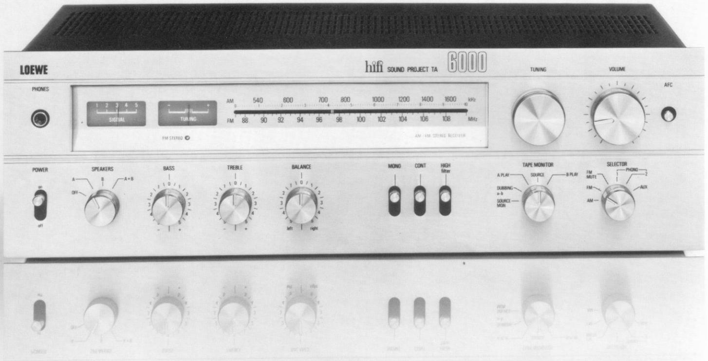
der-Mitten-Anzeige ermöglichen die präzise Abstimmung des Empfängers auf einen gewünschten Sender, wobei die AFC-Schaltung hilft. Das FM-Mute unterdrückt das Zwischenstationsrauschen. Die mono-stereo-Umschaltung kann von Hand erfolgen, wird aber bei empfangsunwürdigen Stereosendungen auch automatisch vom Decoder besorgt. Als Lautsprecherbox empfehlen wir für den Receiver Loewe TA 6000, Typ SX 6773 die optimal angepaßte B 45.
