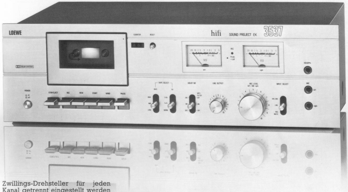
Zwillings-Drehsteller für jeden Kanal getrennt eingestellt werden kann. Als Spitzenwertanzeige dient eine Leuchtdiode. Das HiFi-Cassetten-Deck Loewe EK 3537 ist mit einem kombinierten Longlife-Aufnahme-/Wiedergabekopf und einem Long-
