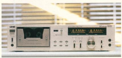
regler, VU-Meter mit Peak-Anzeige, Eingangsschalter für DIN und Line, Recordmute, Full-Auto-Stop, 3-stelliges Zählwerk, Frequenzgang 30-18.000 Hz, Gleichlaufschwankung 0,12%.
