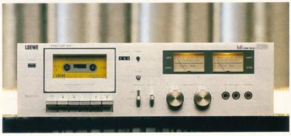
VU-Meter, Mikrofoneingang rechts und links getrennt, Kopfhörerausgang, Cassettenfachtür bedämpft, Full-Auto-Stop, 3-stelliges Zählwerk, Frequenzgang 30-16.000 Hz, Gleichlaufschwankungen 0,14%.
