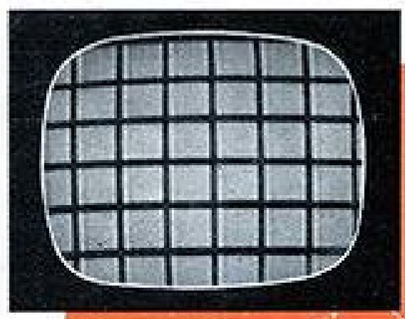
Fig. 16. — Image résultant d'un dérèglement important de l'oscillateur.
