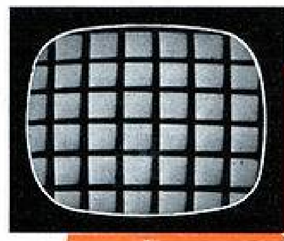
Fig. 17. — Un autre aspect de l'image pouvant provenir d'un oscillateur dérégulé.
