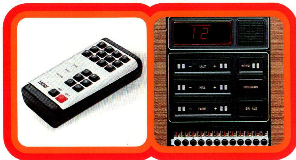
Ultraschall-Fernbedienung »Teleoptimat-T« mit 20 Steuerfunktionen.
