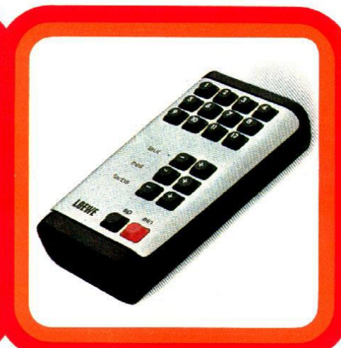
Die Ultraschall-Fernbedienung »Tele-optimat-T« mit 20 Funktionen in Direktwahl: 12 Programme, Ein/Aus, Lautstärke, Helligkeit, Farbkontrast sowie »Testomatic« für Ideal-Grundeinstellung oder »Time« für Zeit- und Programmanzeige (bei Geräten mit Digitaluhr).
