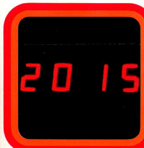
Elektronische Digitaluhr für wechselweise Zeit-, Datums- und Programmanzeige und zur Programmierung gewünschter Ein- und Ausschalttermine.
