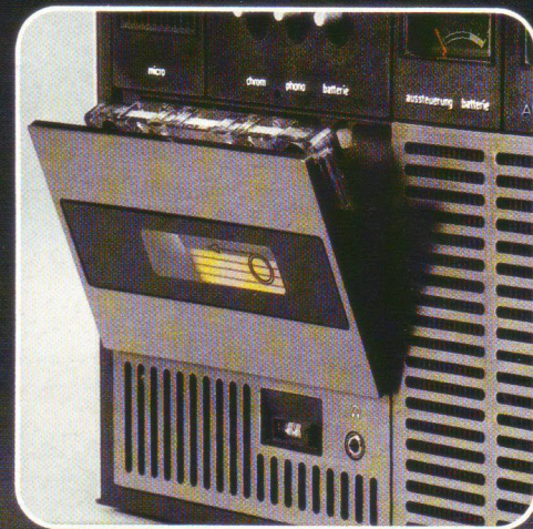
Zählwerk für Cassette (unter Cassettenfach) Anschluß für Ohrhörer.
