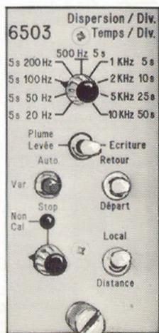
Ce tiroir est un accessoire du 6303 quand ce dernier est utilisé en analyseur de spectre, il permet le balayage du tiroir 6303, la durée de l'analyse étant déterminée en fonction de la dispersion qui est variable de 20 Hz/division à 10 kHz/division.
