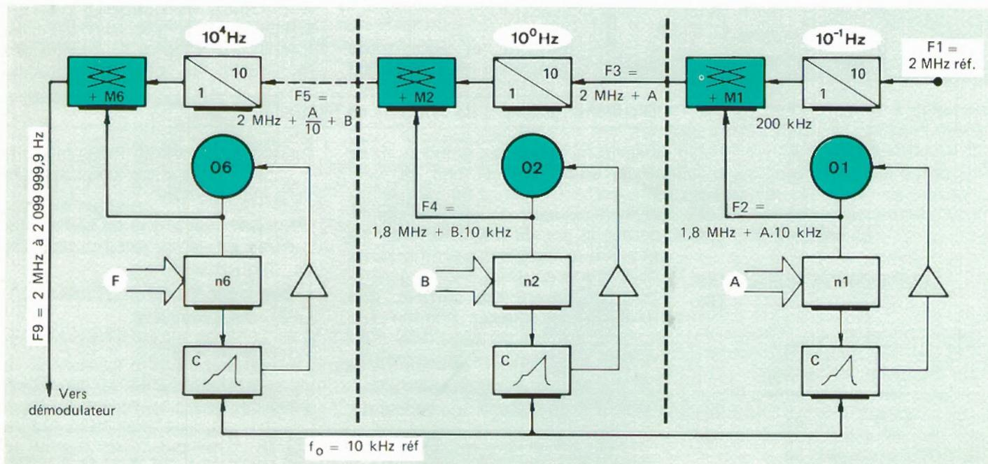
Un oscillateur OSC délivre une fréquence variable  $F$ , cette fréquence est divisée par un compteur dont le taux de division (programmable de  $n1$  à  $n2$ ) est rendu variable par l'introduction de la valeur codée  $N$  correspondant au chiffre à «synthétiser».
