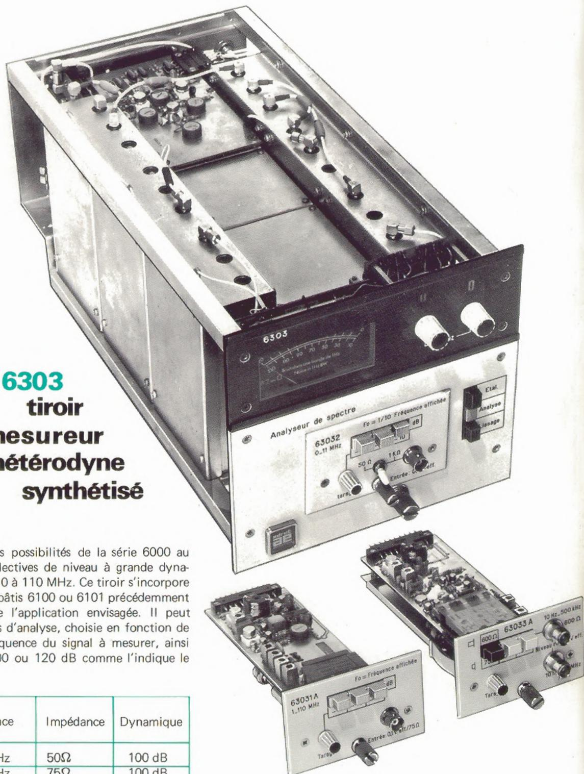
**Analyseur de spectre :** cet analyseur de spectre est constitué du tiroir 6303, du bâti 6100 et du tiroir de balayage 6503, il ne prétend pas se substituer aux analyseurs panoramiques, mais il s'impose lorsque les spécifications de ces derniers s'avèrent insuffisantes tant en résolution qu'en dynamique.
