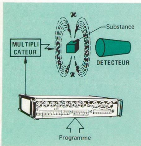
trique sur une longueur d'onde déterminée, lorsque ce corps est soumis à un champ magnétique variable mais homogène. On met ainsi en évidence des raies d'absorption dont la position relative, la forme et l'intensité, permettent d'obtenir des renseignements sur la structure des molécules organiques, la symétrie des cristaux et les distances inter-atomes.
