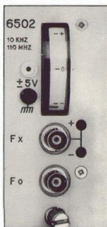
Ce tiroir met en évidence l'écart de fréquence existant entre la fréquence affichée sur le synthétiseur ( $F_o$ ) prise comme référence, et une fréquence extérieure ( $F_x$ ), cet écart étant visualisé sur un galvanomètre et par deux voyants «+» et «-». Ce tiroir est utilisable dans la gamme de 10 kHz à 150 MHz.
