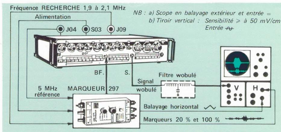
Fig. 1 - Inter connexion entre le 297 et synthétiseur wobulé.
