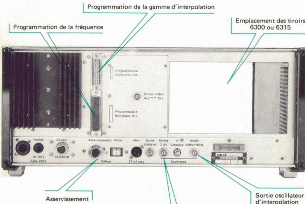
La série 6000 comprend deux bâties, une version complète le 6100 permettant d'obtenir toutes les fonctions des générateurs de fréquence (modulation, wobulation ...) et une version simplifiée, le modèle 6101. En utilisant l'un ou l'autre de ces deux bâties, l'utilisateur est assuré de disposer d'un instrument parfaitement adapté à l'utilisation envisagée :
