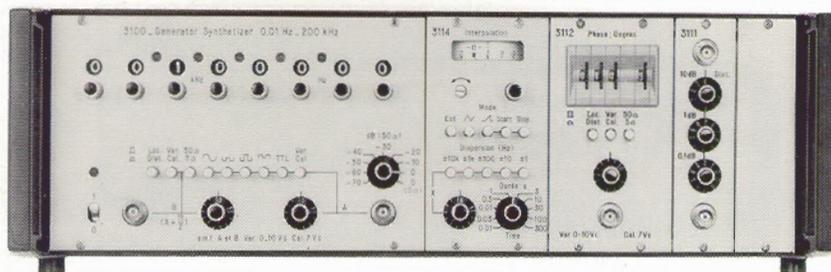
Afin de satisfaire les besoins souvent spécifiques des utilisateurs de la gamme BF/TBF, adret a développé le 3100 générateur synthétiseur de fréquence à options câblées, cet appareil est constitué d'un châssis de synthèse comportant l'affichage de la fréquence et les circuits de sortie. Il comporte, en outre, une alvéole susceptible de recevoir 1 à 3 options choisies parmi les 4 disponibles.
