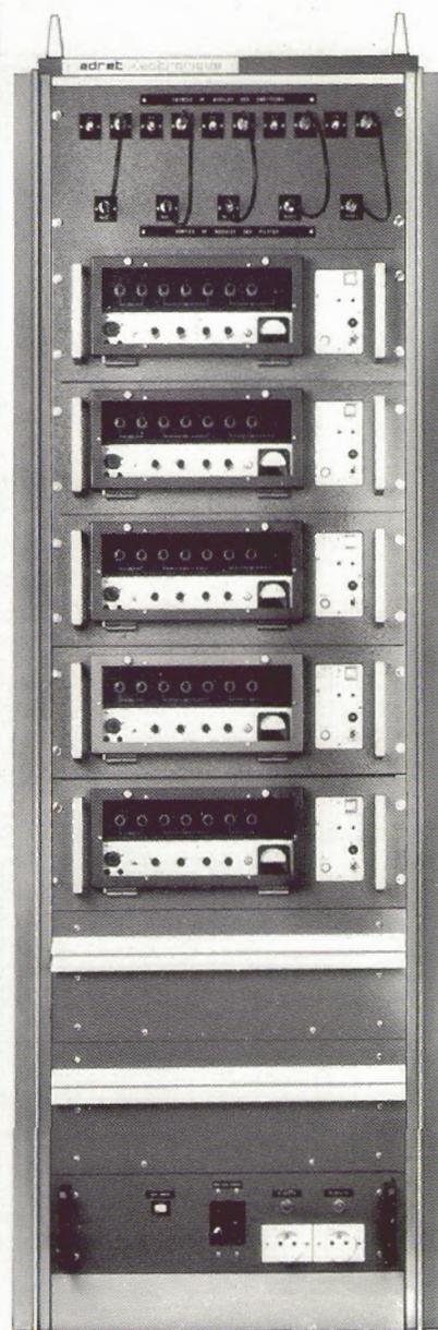
*L'équipement comprend de 1 à 5 pilotes pour 10 émetteurs. Le mixage s'effectue à partir d'une platine de commutation située sur la partie supérieure de la baie. Chacun des 10 émetteurs peut donc être piloté par 5 fréquences au choix.*
