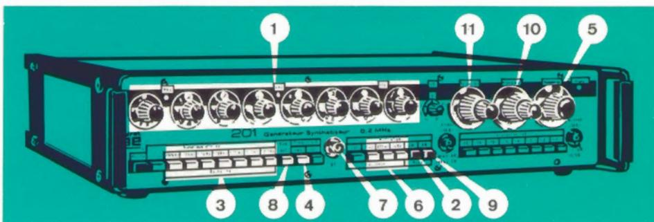
Trois touches permettent ensuite de choisir l'une des fréquences de modulation ou de wobulation internes de 50 Hz, 400 Hz, 1000 Hz qui sont également disponibles sur la prise BF.
