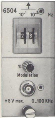
Ce tiroir permet d'étendre la résolution de fréquence du bâti 6100 au 1/100 de Hertz, tout en gardant la possibilité d'effectuer une modulation AM ou FM par signaux extérieurs. (PM avec tiroir 6315). L'augmentation de la résolution ne dénature pas les caractéristiques mentionnées auparavant, les pas de 1/10 et 1/100 de Hz ainsi élaborés sont également programmables ; leur temps d'acquisition étant de 1 ms.
