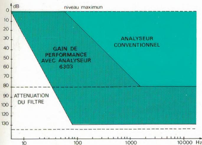
**Décibelmètre hétérodyne :** cet instrument comprend le tiroir 6303 et la version simplifiée du bâti, le 6101, il permet la mesure du niveau de signaux à des fréquences connues, de séparer les composantes de signaux complexes, de mesurer des signaux perturbés par du bruit. Enfin, il est possible de mesurer l'énergie dans une bande de 10 Hz\* à une fréquence définie.
