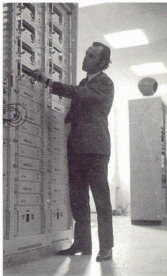
met à tout moment, soit le contrôle des fréquences d'asservissement (5 MHz), soit le contrôle des fréquences de pilotage directement ou par l'intermédiaire d'un commutateur coaxial télécommandé à partir du pupitre.
