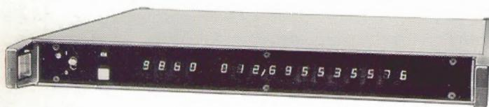
L'interface Adret 414 permet la programmation en code ASCII des instruments programmables en code BCD parallèle.
