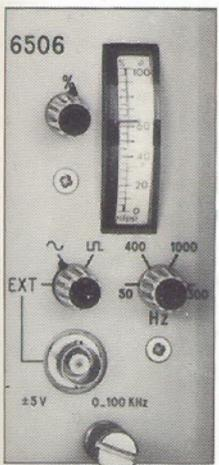
Ce tiroir comporte un générateur BF à points fixes délivrant des signaux de forme sinusoïdale ou carrée, pour modulations AM, FM ou PM (avec tiroir 6315). Il garde la possibilité d'effectuer ces modulations par signaux extérieurs.
