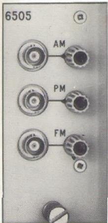
Ce tiroir permet d'effectuer des modulations AM, FM et PM (avec 6315), avec réglage indépendant des taux de modulation AM de l'excursion FM choisie à partir de l'interpolateur du bâti 6100 et de la déviation de phase en PM.
