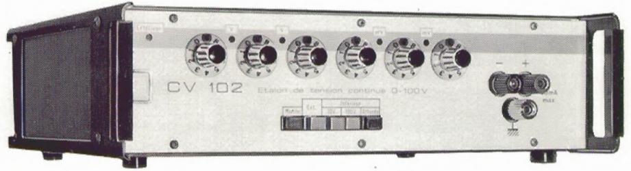
**La particularité de cet appareil réside dans le procédé original de conversion «numérique/analogique» utilisé pour la génération de la tension continue.**
