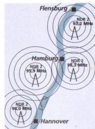
Empfangsfrequenzen des gehörten Senders verändern sich und dementsprechend sind die Empfangsqualitäten je nach Bedingung sehr unterschiedlich. Das Autoradio mit RDS schaltet immer auf die aktuelle und passende Alternativ-Frequenz des gehörten Senders. Sie fahren also zum Beispiel von Flensburg nach Hannover und hören auf dem ganzen Weg NDR 2. Sicher und bequem, ohne ablenkendes Umschalten oder manuelle Suchlaufbedingung. Und immer auf bestem Empfang.
