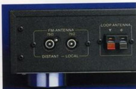
Der FT 880 verfügt über zwei getrennte Antennen-Eingänge: „Local“ für starke Ortssender oder Kabelanschluß, „Distant“ für schwächere und entferntere Sender.
