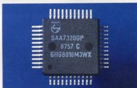
Um die Vielfalt digitaler Funktionen noch stärker zu integrieren und zugleich die Klangqualität noch weiter zu verbessern, verwendet Philips im CD 840 neueste IC-Technologie für die 1-Bit-Strom-D/A-Wandlung. Dabei arbeiten zwei dieser Chips im sogenannten Differenz-Modus für eine höchstmögliche Klangqualität.
