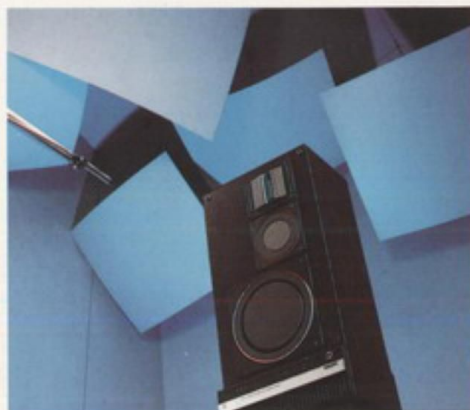
In de Philips laboratoria worden fundamenteel nieuwe technieken ontwikkeld voor geluidswaergave. Hiernaast een proefopstelling voor het testen van vlakke-membraan luidsprekers.
