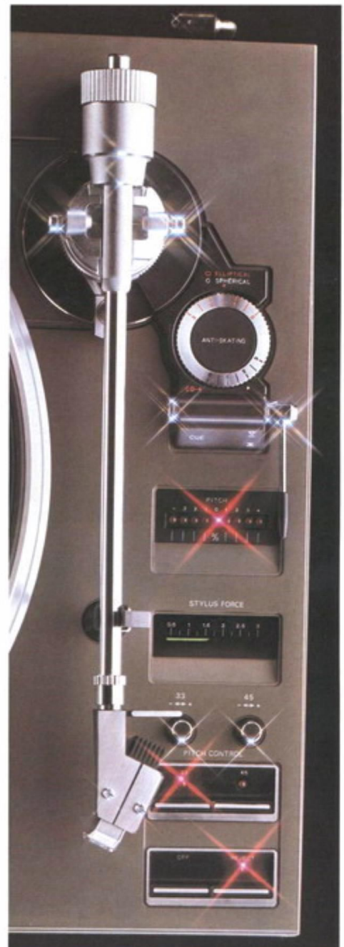
Overzichtelijk bedieningspaneel met precisie-instelling voor dwarskrachtcompensatie, handle voor armlift, LED-schaal voor aflezing snelheid, naaldkrachtmeter, draairegelaars voor snelheidsbijregeling, LED-tiptoetsen voor snelheidskeuze (33 of 45 t.p.m.), uitschakelen en reject.
