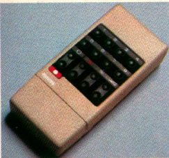
Ultraschall-Fernbedienung Serienmäßig eingebaut. Jede Einstellung des Programms, der Lautstärke, Helligkeit und Farbsättigung wird drahtlos übermittelt – bequem vom Sessel aus.
