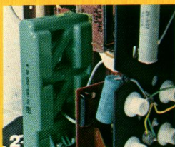
25.000-Volt-Kaskade mit Silizium-Dioden: stabil und zuverlässig.
