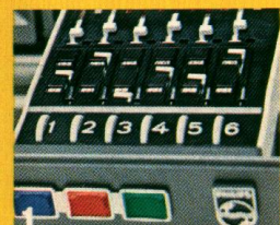
Memomatic Speicher-Modul – speichert nach einmaliger Vorwahl die optimale Einstellung jedes Fernseh-Senders.
