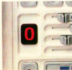
Bereitschaftschaltung Über Ultraschall-Fernbedienung kann das Gerät auf Bereitschaftsbetrieb geschaltet werden. In der Programm-anzeige leuchtet die „0“ auf. Das heißt: Bild und Ton sind abgeschaltet, erscheinen aber auf Tastendruck sofort wieder.
