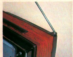
Eingebaute Teleskopantenne ist leicht beweglich und macht die Fernseh-Philetta von einer weiteren Antenne meist unabhängig.
