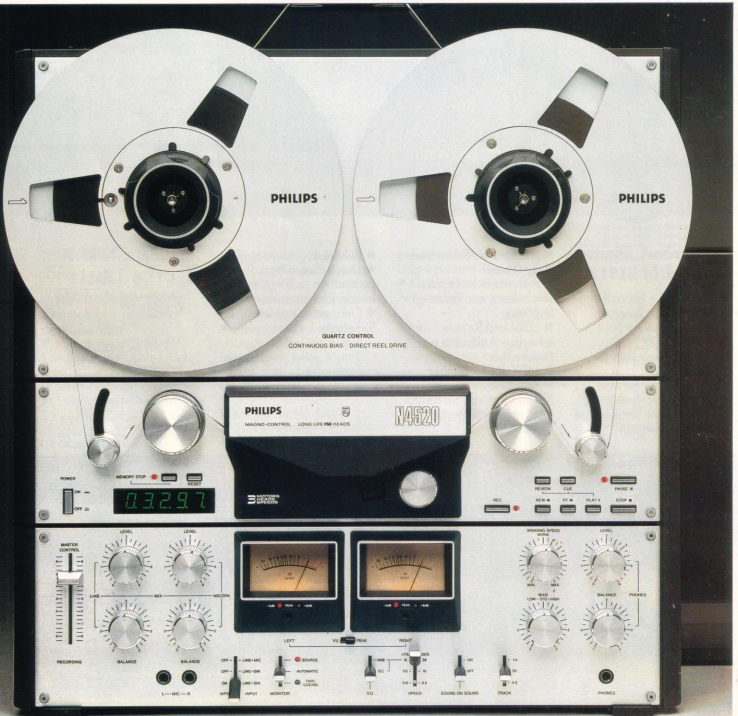
großen Bereichen stufenlos regeln. (WIND SPEED.) Außergewöhnlich ist auch die Vormagnetisierung. Wie bei professionellen Studio- maschinen kann die Vormagnetisierung mit dem Bias-Regler stufenlos optimiert werden. In der rastenden Mittelstellung ist das Gerät auf das DIN-Bezugsband eingemessen.
