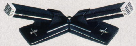
N 8404 HiFi-Stereo-Electret-Mikrofon für alle Philips Stereo-Cassetten-Recorder und Stereo-Spulengeräte. Mit 2 trennbaren Systemen. Empfindlichkeit: 2 x 0,25 mV/μbar. Frequenzbereich: 50–18 000 Hz (DIN 45 500). Impedanz: 2 x 800 Ohm. Ausführung: mit 2 Klinkensteckern 6,3 mm. DM 75,—*
