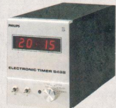
LFD 2432 Elektronisch einstellbare Digital-Schaltuhr zum präzisen Einschalten der angeschlossenen Geräte (z. B. Cassetten-Recorder, Spulentonbandgerät, Tuner, Amplifier). Mit dem Zentralschalter auf der Frontplatte des Timers lassen sich alle 4 Steckdosen gemeinsam ein- und ausschalten, wobei die vorgeählte Zeit-Schaltfunktion Vorrang behält. Abmessungen der Front: B x H: 102 x 143 mm. Kombination Timer + Cassetten-Deck N 2542: 482 x 143 mm. Front: Metall, silberfarben. DM 179,—*
