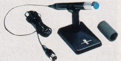
N 8310 HiFi-Electret-Mikrofon Kugelcharakteristik. Empfindlichkeit: 0,3 mV/μbar. Frequenzbereich: 20–20 000 Hz (DIN 45 500). Mit Tischstativ und Windschutz für Nahbesprechung. Stativgewinde 3/8". Ausführung: Klinkenstecker 6,3 mm. DM 90,—*
