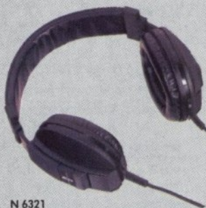
N 6321 HiFi-Electret-Stereo-Kopfhörer Electret-Kondensatorprinzip. Frequenzbereich: 20–20 000 Hz Impedanz: 1000 Ohm bei 500 Hz Gewicht: 380 g Ausführung: Klinkestecker 6,3 mm DM 69,-*
