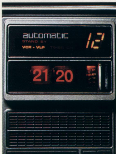
Zweistellige 7-Segment-Leuchtziffer-Programmanzeige. Dazu Digitaluhr mit Schaltautomatic.
