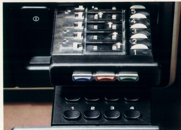
Reservebedienung verdeckt in einer 2. Schublade unterhalb des Memomatic-Programmspeichers.
