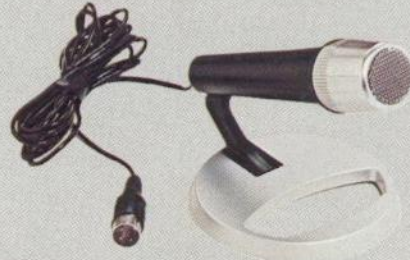
N 8307 Dynamisches Breitband-Mikrofon für alle Geräte. Nierencharakteristik. Empfindlichkeit: 0,24 mV/μbar. Frequenzbereich: 80-20 000 Hz. Impedanz: 500 Ohm. Stativgewinde: 3/8". DM 80,-*
