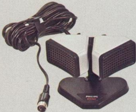
N 8402 Dynamisches Stereo-Mikrofon für N 2400, N 2405, N 2408, N 2407, N 2509, N 2515, N 2520, N 4415, N 4417, N 4419, N 4511 und N 4450. Mit 2 trennbaren Systemen, Nierencharakteristik. Frequenzbereich: 120-16 000 Hz. Empfindlichkeit: 0,33 mV/μbar. DM 80,-
