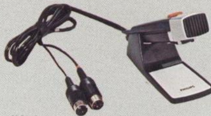
N 8210 Dynamisches Mikrofon mit Start/Stop-Schalter für EL 3302, N 2209 AV, N 2212, N 2217, N 2221, N 2222, N 2223, N 2225. Kugelcharakteristik. Empfindlichkeit: 0,27 mV/μbar. Frequenzbereich: 63-17 000 Hz. Impedanz: 500 Ohm. DM 33,-
