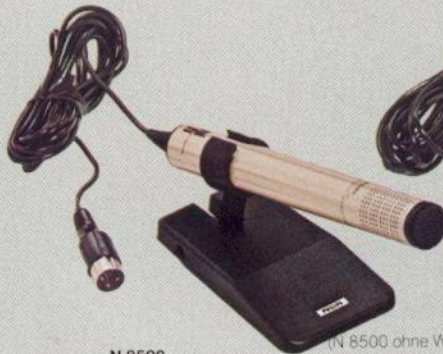
N 8500 HiFi-Electret-Mikrofon für alle Geräte. Nierencharakteristik. Empfindlichkeit: 0,25 mV/μbar. Frequenzbereich: 35-18 000 Hz (nach DIN 45 500). Mit Tischstativ und Windschutz für Nahbesprechung. DM 140,-*
