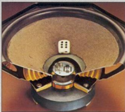
Das quadratische piezokeramische Element in der runden Printplatte ist das Herzstück des MFB-Lautsprechers.
