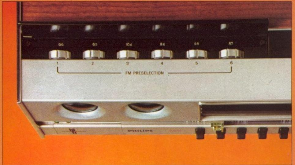
Abstimmregler für die Philips Electronic-Memomatic zur UKW-Programmspeicherung.
