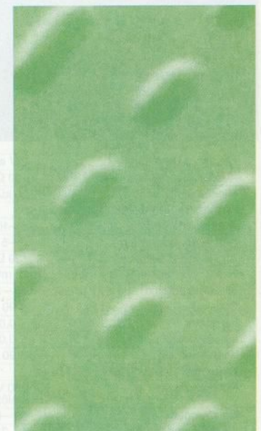
Oberfläche einer Compact Disc, 12.500fach vergrößert: Die mikroskopisch kleinen Berge, die „Pits“, transportieren die digitalisierte Klang-Information.
