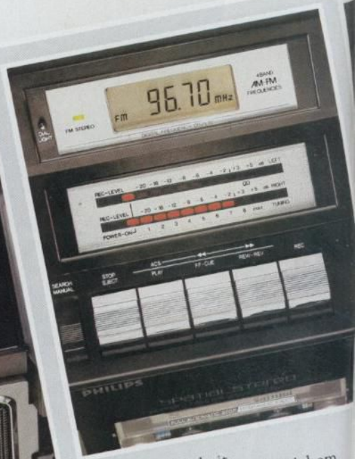
Die Kontrolleinheit. Hier sehen Sie exakt, auf welchem Wellenbereich und welcher Frequenz Sie gerade empfangen, ob in Stereo oder Mono. Die Anzeige-Displays zeigen die Stärke des Empfangssignals oder wie hoch die Cassette angesteuert ist.
