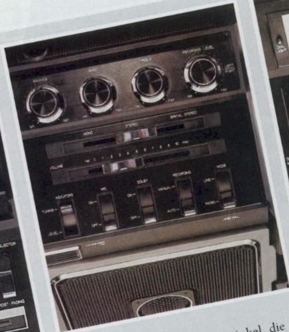
Das Regiepult. Hier bedienen Sie Stereo-Weitwinkel, die Klangregler, die Lautstärke. Hier wählen Sie aber auch, ob automatisch oder manuell angesteuert werden soll. Ob von der HiFi-Anlage oder über...
