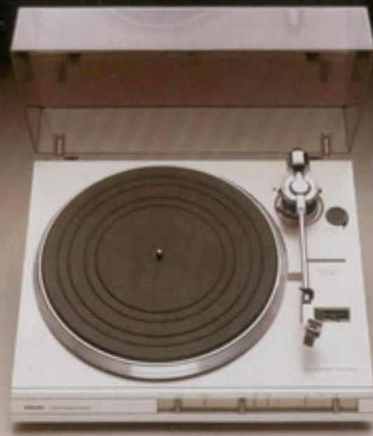
F 7211 Automatische HiFi platenspeler. Frontbediening. Snaaraandrijving, Jengel 0,05% WRMS, rumble -60 dB DIN-B. Instelbare dwarskrachtcompensatie en naaldkrachtmeter. Antimagnetische draaitafel. Super-M HiFi element GP 500.
