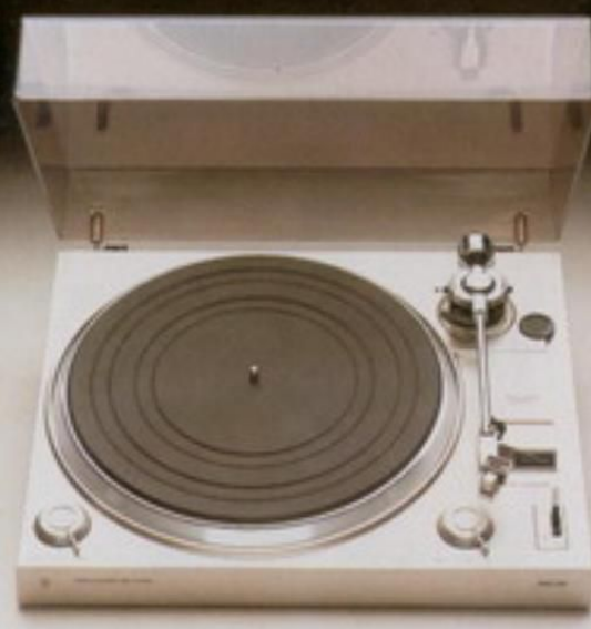
F 7113 Automatische HiFi platenspeler. Snaaraandrijving, Jengel 0,05% WRMS, rumble -60 dB DIN-B. Instelbare dwarskrachtcompensatie en naaldkrachtmeter. Antimagnetische draaitafel. Super-M HiFi element GP 500.
