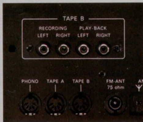
DIN én cinch aansluitingen. DIN voor platenspeler, tape A en tape B. Bovendien cinch voor tape B.
