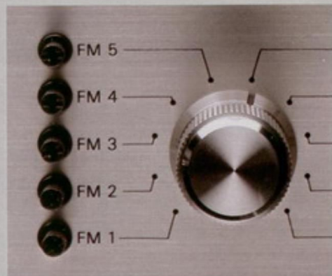
Centrale programma-selector. Voor keuze van vijf FM voorkeuzenders FM manual, middengolf, platenspeler, tape A en tape B.
