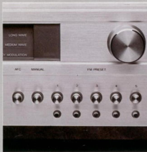
Elektronische afstemming op vijf FM voorkeuzenders, gekoppeld aan verlichte naaldindicator voor FM voorkeuzinstelling en inschakelbare automatische FM fijnafstemming (AFC).
