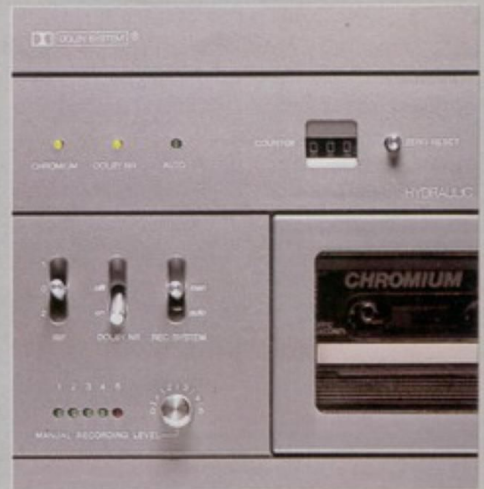
Dolby ruisonderdrukkingssysteem. Inschakelbaar voor feilloze weergave van alle typen cassettes. De opnamesterkte kan naar keus automatisch of met de hand worden geregeld, gekoppeld aan een LED schaal voor aflezing van het piekwaardenniveau.
