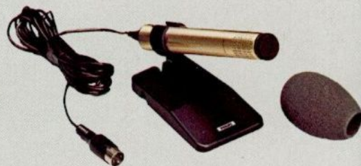
N 8500 (N 8501) HiFi-Electret-Mikrofon Super-Nierencharakteristik. Empfindlichkeit: 0,35 mV/µbar. Frequenzbereich: 50–18 000 Hz (DIN 45 500). Ausführung: mit 3pol. 180° DIN-Stecker. Mit Tischstativ und Windschutz für Nahbesprechung. Stativgewinde 3/8". DM 140,-
