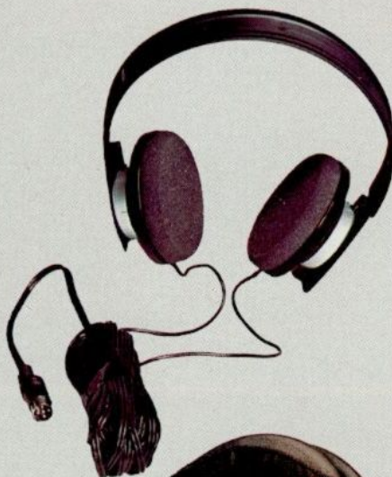
N 6310 HiFi-Stereo-Kopfhörer zum Anschluß an Tonbandgeräte, HiFi-Verstärker und Fernsehgeräte. Offenes Kapselsystem. Frequenzbereich: 20–20 000 Hz. Anschluß: 5pol. 360° DIN Kopfhörerstecker. Mit beiliegendem Adapter zum Umrüsten auf Klinkestecker. Impedanz: 2 x 600 Ohm. Gewicht: nur 160 g. DM 75,-
