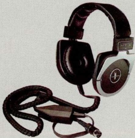
N 6325 HiFi-Electret-Stereo-Kopfhörer zum Anschluß an Tonbandgeräte, HiFi-Verstärker und Fernsehgeräte. Electret-Kondensatorprinzip. Frequenzbereich: 20–22 000 Hz. Impedanz 1000 Ohm bei 500 Hz. Gewicht 230 g. Ausführung: Klinkestecker 6,3 mm. Mit beiliegendem Adapter zum Umrüsten auf 5pol. 360° DIN Kopfhörerstecker. DM 98,-
