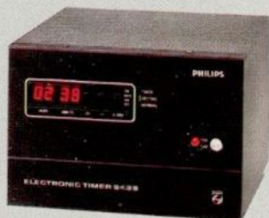
LFD 2438 und LFD 2441 Elektronisch einstellbare Digital-Schaltuhr zum präzisen Ein- und Ausschalten der angeschlossenen Geräte (z. B. Cassetten-Recorder, Spulentonbandgerät, Tuner, Amplifier). Mit dem Zentralschalter auf der Frontplatte des Timers lassen sich alle 5 Steckdosen gemeinsam ein- und ausschalten, wobei die vorgewählte Zeit-Schaltfunktion Vorrang behält. Abmessungen der Front: B x H: 188 x 143 (mm). Farbe: LFD 2438 silber, LFD 2441 schwarz und silber DM 179,-
