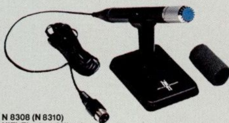
N 8308 (N 8310) HiFi-Electret-Mikrofon Kugelcharakteristik. Empfindlichkeit: 0,3 mV/µbar. Frequenzbereich: 20–20 000 Hz (DIN 45 500). Mit Tischstativ und Windschutz für Nahbesprechung. Stativgewinde 3/8". Ausführung: mit 3pol. 180° DIN-Stecker. DM 90,-
